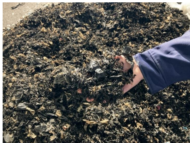
廃農ポリ破砕後のフラフ
